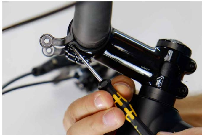
2. Schrauben Sie die beiden Halterarme an dem Lenker fest.
