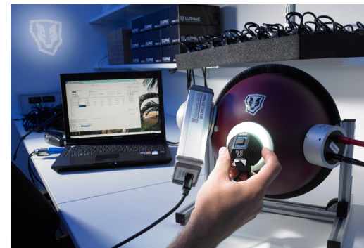
Messung der Lichtleistung
